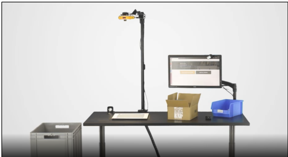
Abbildung 5: Sortiertisch mit Kamera und Tablet zur Bildererkennung
