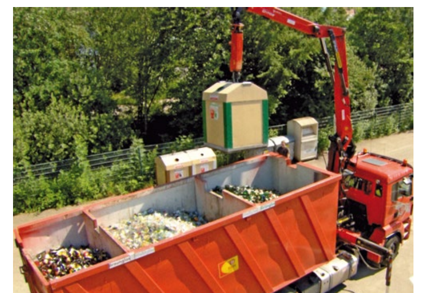
Foto: Sammelfahrzeug mit getrennten Kammern für die Altglas-Sammlung
