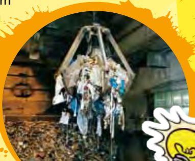
3 Tonnen schafft der Greifarm auf einmal.
