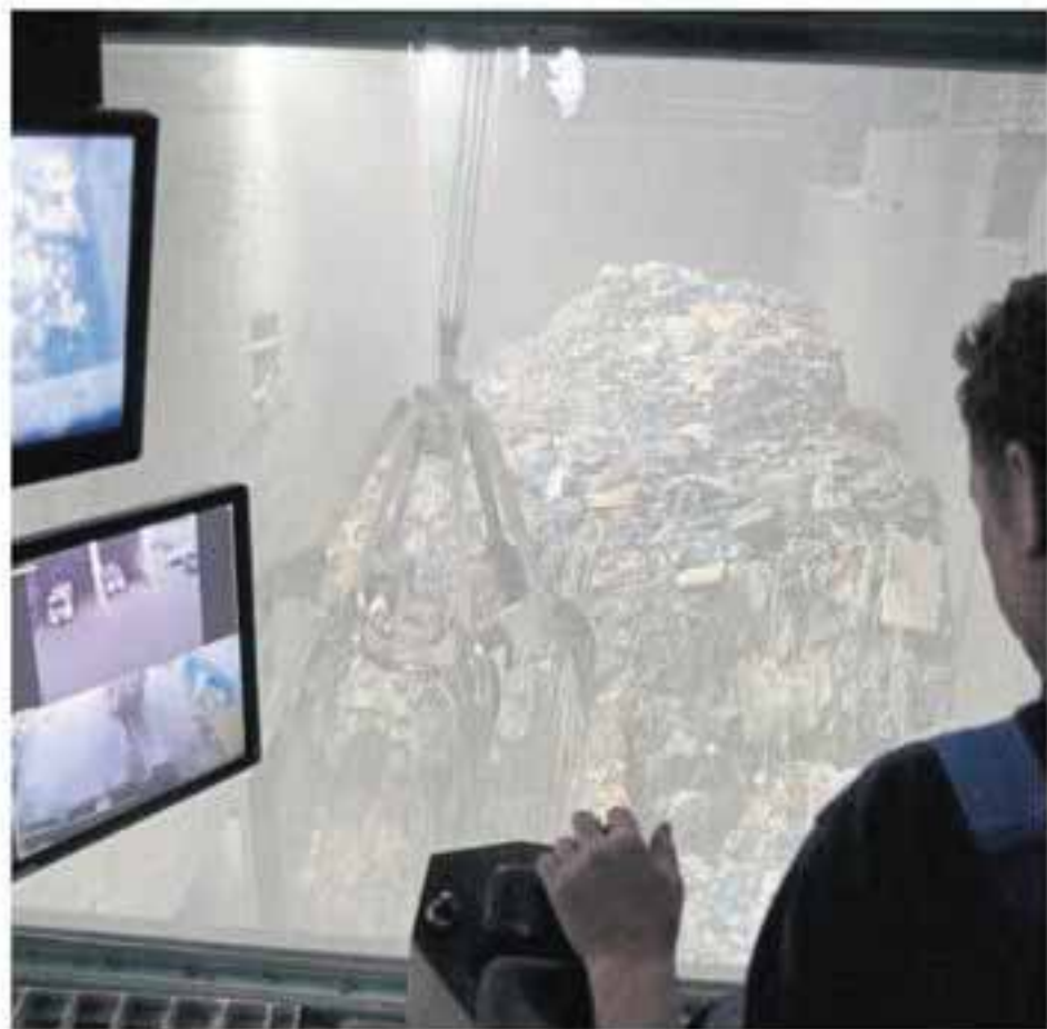
In der Krankkabinen: Sie muss 24 Stunden täglich besetzt sein. Der Greifer schafft bis zu drei Tonnen Restmüll auf einmal.
