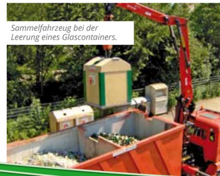
Sammelfahrzeug bei der Leerung eines Glascontainers.
